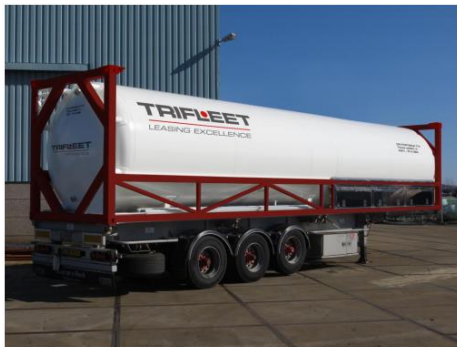
Picture: Standard 40' – 46000L 7/10 barg UN Portable T75 / ADR R14,3BN LNG tank.
